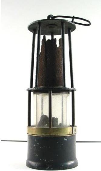
Lampe de mineur, fer, laiton, verre, Lobsann, vers 1890
